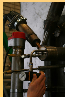
Vår 150 kW brännkammare klarar nu alla slags flytande bränslen, allt ifrån lågviskösa vätskor till tjocka oljor
