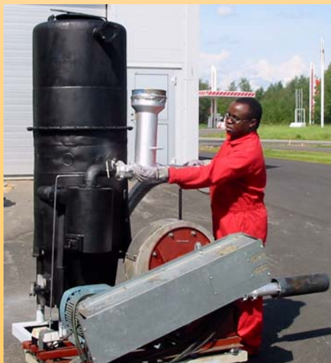
Francis Nturanabo intill den förgasare som skall möjliggöra en god förbränning av jordbruksrester i Uganda.
