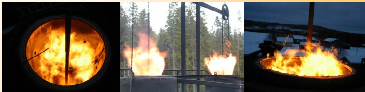
T.v: Topp vy av fackelbrännkammare med kon stag. Mitten:Facklor innan omdesign. T.h: Fackla efter omdesign
